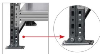
Подпятник с отверстием под анкер. Крепится к стойке двумя болтами М8
