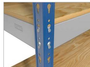
Балка крепится к стойке на зацепах. Зацеп уже выштампован в стойке. Установка балок занимает минимальное время
